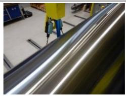
Bild 5: Der Sensor, der von oben auf die Walze aufsetzt, erfasst die Höhenlage der Walze und vereinfacht so das Ausrichten in der Maschine.
