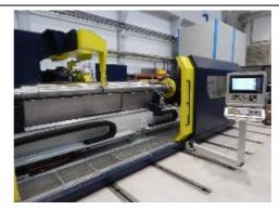
Bild 4: Das integrierte Dreipunkt-Messsystem erfasst die Geometrie und die Lage der Walzen mit höchster Präzision.
