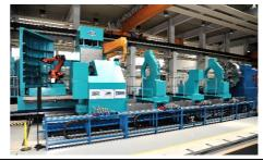
**Bild 5:** Die Werkzeugarena fasst bis zu 106 Werkzeuge.
