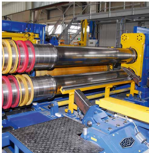
Automatic tool change on the slitting shear / Auto- matischer Werkzeugwechsel an der Längsteilschere
