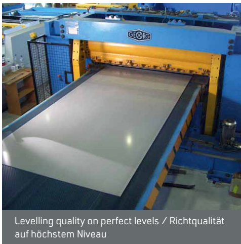
GEORG high-performance leveller RM 70 x 2,000 with semi automatic cassette changing / GEORG Hochleistungsrichtmaschine RM 70 x 2.000 mit halbautomatischem Kassettenwechsel
