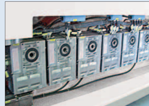
Abstützungsverstellung mittels DS-Kompaktmotoren Backupadjustment via AC compact motors
