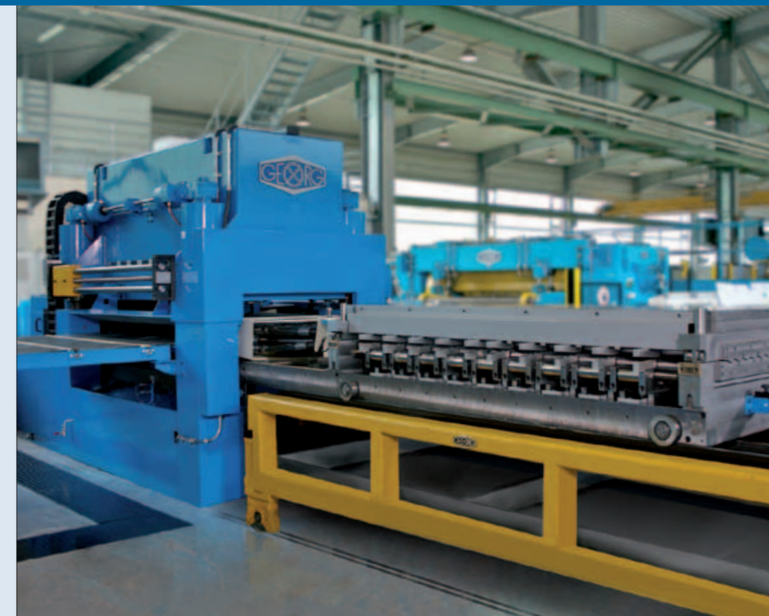
Richtmaschine mit vollautomatischem Kassettenwechselsystem Leveller with full automatic cassette changing system
