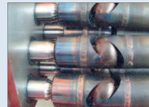
Kugelgelenkwellen für hohe Drehmomente Universal shafts for heavy torque
