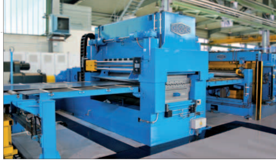
Hochleistungsrichtmaschine für SSC (TYP: RM70/17/9-6h-2000) High performance leveller for SSC
