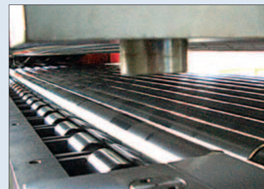
„Four-high“- oder „Six-high“-Walzenkassette „Four-high“ or „six-high“ roller cassette
